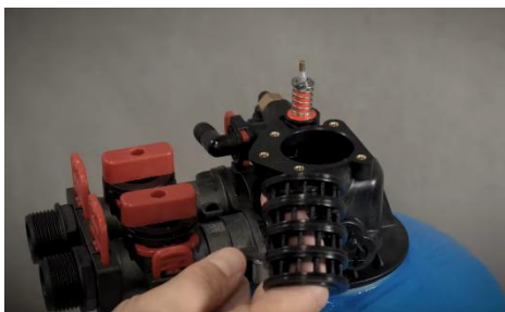
Neuen Kolben und Dichtsatz einsetzen.
