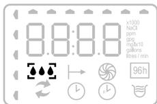
Wasserverbrauchsanzeige „Tröpfchen“ auf dem Display „laufen“, während Wasser durch den Enthärter fließt. Es ist praktisch, um den Wasserverbrauch zu überwachen und Wasserlecks zu erkennen.
