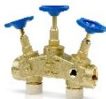
Aquintos Montageblock - Anschluss-Armatur 2 Zoll IG x 2 Zoll AG mit Bypass und Verschneideeinheit für Enthärtungsanlagen und Filteranlagen DN50 Rohrleitungen
